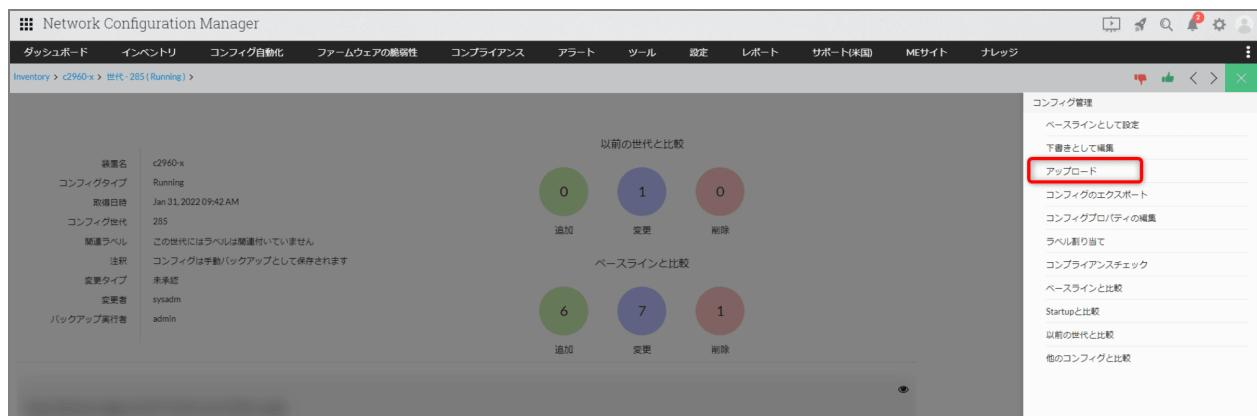
4. アップロード対象のコンフィグタイプ (Startup/Runningコンフィグ) を選択し、実行タイミング (即時/スケジュール) を指定
